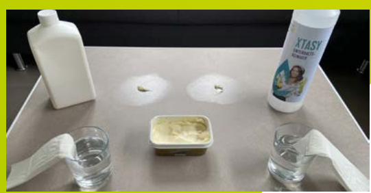
Praxistest: Fliesenfläche wird mit Butter benetzt, in je 100 ml Wasser werden 1 ml Reiniger gemischt
